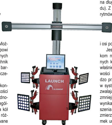
Urządzenie do pomiaru geometrii 3D z ruchomą belką poziomą podążającą za ruchem tarcz refleksyjnych.
