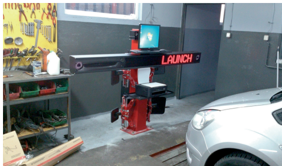
Wersja kanałowa urządzenia 3D ze słupem umieszczonym centralnie.
